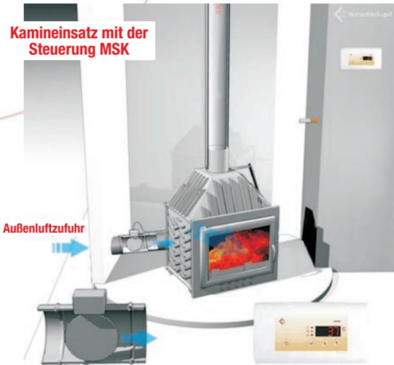
Die elektronische Steuerung des Kamineinsatzes ist eine Vorrichtung, die für stabilen Luftdurchfluss in dem Kamin während der Verbrennung des Holzes verantwortlich ist. Dies hat zum Ziel, die Temperatur der Feuerstelle zu überwachen und konstant zu halten, was im Endeffekt den Verbrennungsprozess verlängert und dadurch das Brennholz spart. Beaufsichtigt wird die Temperatur der (durch den Kamin) erhitzten Luft oder des Wassers (beim Kamineinsatz mit Wassermantel).
